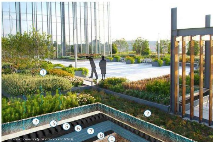
1. Vegetación de cubierta intensiva 2. Vegetación de cubierta extensiva 3. Sustrato: profundidad variable en función de si la cubierta es intensiva o extensiva 4. Filtro 5. Sistema de drenaje 6. Barrera antiarborescentes 7. Aislamiento 8. Sistema de impermeabilización 9. Estructura del edificio
