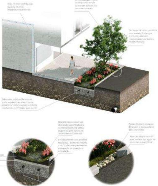
Figura 9. Canteiro Pluvial (Fonte: Guzman, 2012)
